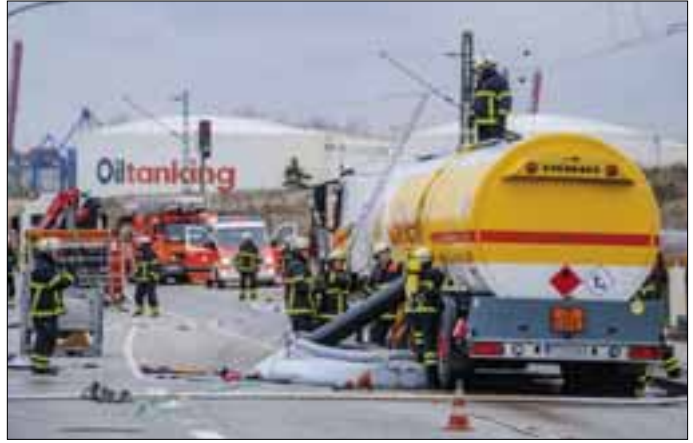
28.03.2019, TH2X, Kattwykbrücke: Abbiegender Autotransporter schlitz Mehrkammer-Tankfahrzeug auf circa 35 Zentimeter Länge auf, 13.500 Liter Diesel und 6.500 Liter Benzin laufen aus, umfangreiche Abdichtungsmaßnahmen und Umpumparbeiten
