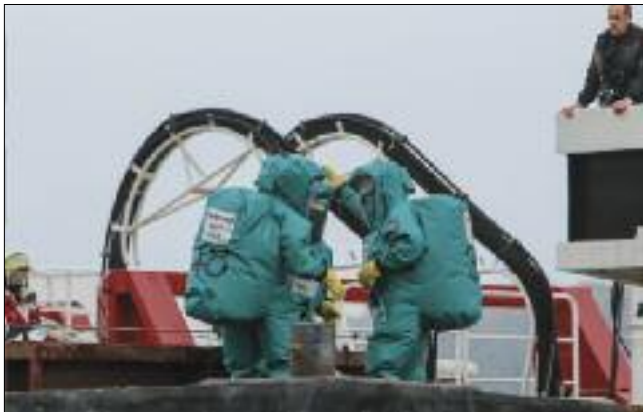
Vernebelungsmittel aus dem Zweiten Weltkrieg: Nach Probenentnahmen und Messungen wird Chlorsulfonsäure festgestellt
