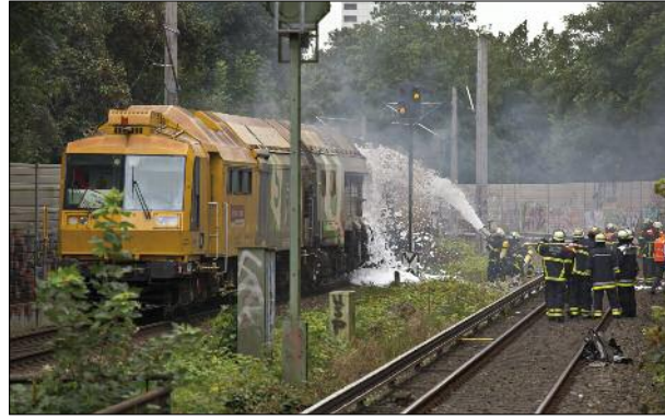
04.08.2016, FEUZUG, Eilbek: Schienenfräse brennt in voller Ausdehnung, Erdung von Oberleitung und Stromschiene, danach massiver Schaumeinsatz
