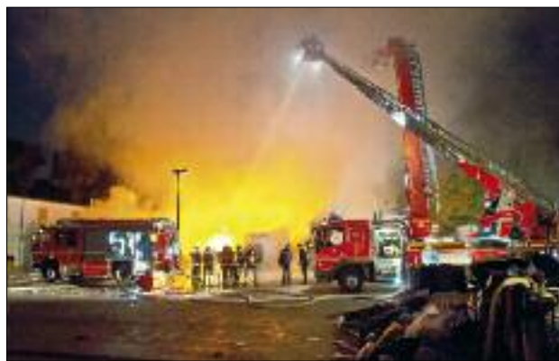
27.10.2015, FEU2, STELLINGEN: Feuer von mehreren Ballen aus Pappe und Plastik auf Recyclinghof, massiver Löschangriff unter anderem mit zwei Wenderohren über Drehleiter und Teleskopmastfahrzeug und dem Einsatz von Schaum
