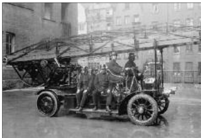
Tradition: Bereits 1907 wurde bei der Feuerwehr Hamburg das erste elektromobile Alarmfahrzeug beschafft - eine „Große Leiter“ von Magirus mit einer Steighöhe von 22 Meter
