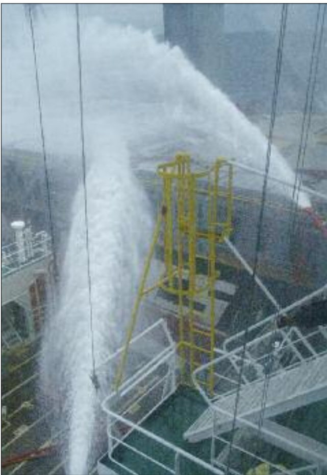
Niederschlagen des Schadstoffaustritts: Einsatzkräfte stellen Schlauchverbindungen her, um den Laderaum der „Purple Beach“ unter Wasser setzen zu können, um den Schadstoffaustritt einzudämmen
