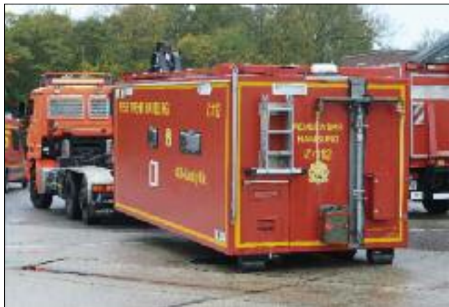
Absatteln: Das mobile Labor wird als „Abfallbehälter – Analytik“ von einem Wechselladerfahrzeug auf den Boden abgelassen, um weitere Proben vor Ort auswerten zu können
