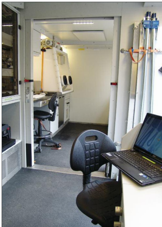
Mobiles Labor: Arbeitsplätze im Abrollbehälter Analytik, die durch eine Schiebetür getrennt werden können
