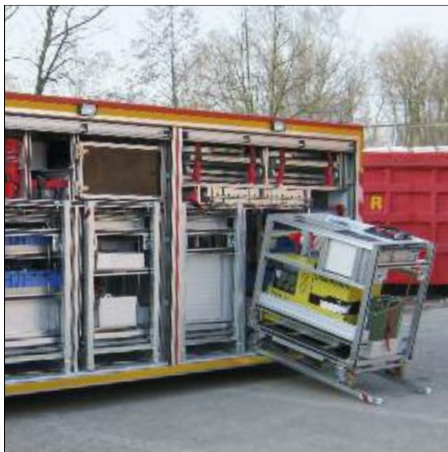
Auch für unwegsames Gelände: der Gerätewagen GWR 1 mit einem verlasteten Rollcontainer. Das Fahrzeug kann zusätzlich mit einem Schneeräumschild ausgerüstet werden. Unten: Die Rollcontainer für den Transport direkt zum Einsatzort, hier verlastet auf dem AB Rüst
