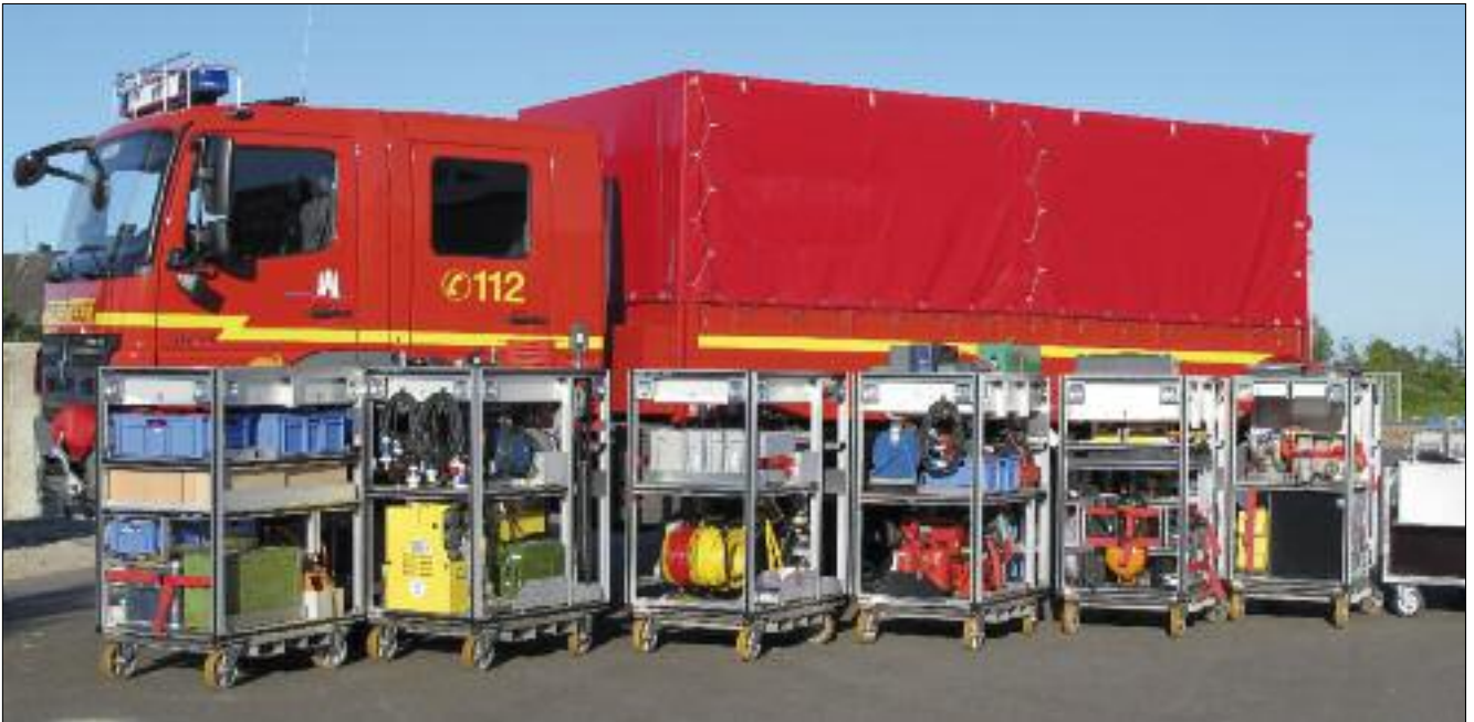
Der Gerätewagen Rüstausstattung 3 (GWR 3) der Freiwilligen Feuerwehr Warwisch. Die leistungsstarke Technik für die technische Hilfeleistung wird in Rollcontainern auf der Ladefläche des Fahrzeugs verlastet
