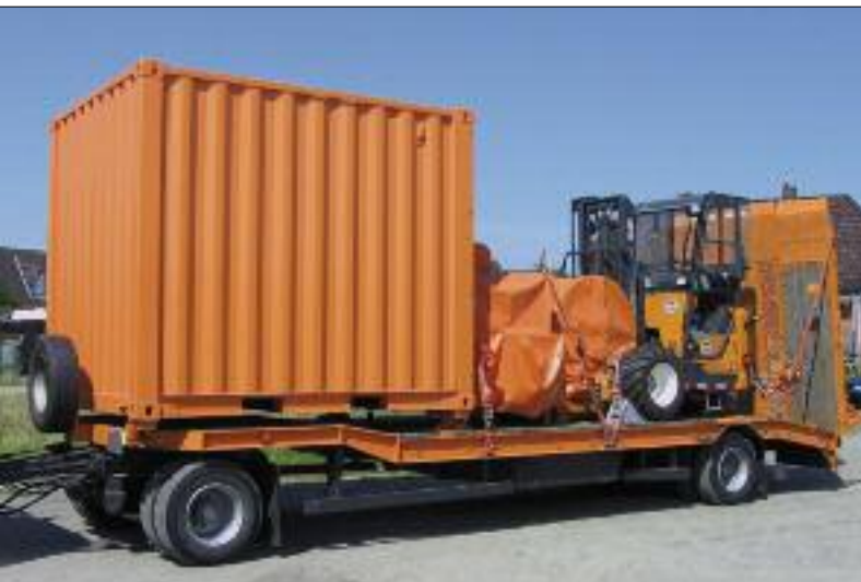
Der Tiefladeanhänger, beladen mit einem geländegängigen Drei-Tonnen-Gabelstapler, Power-Pack, Skimmer und Cargo-Schläuchen
