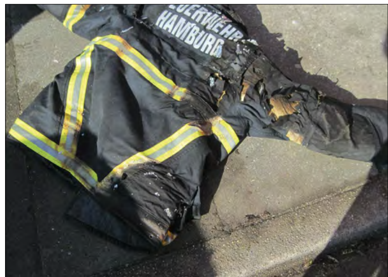
Nach dem Einsatz: Die erste Lage der Überjacken ist komplett weggebrannt
