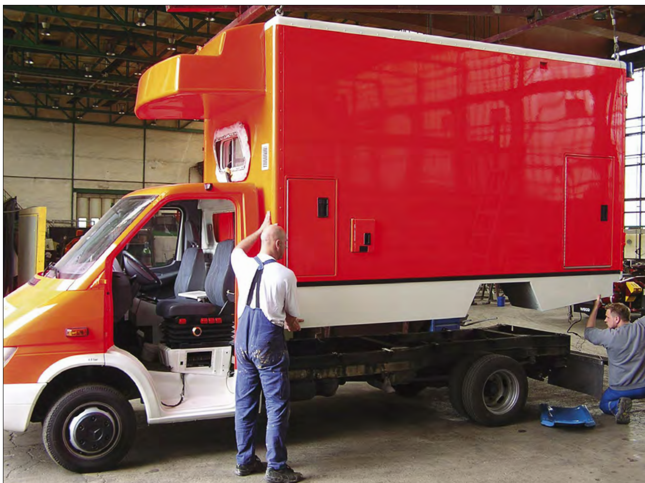
Lohnende Investition: Ist das Fahrgestell verschlissen, lassen sich die hochwertigen Kofferaufbauten auf ein neues umsetzen
