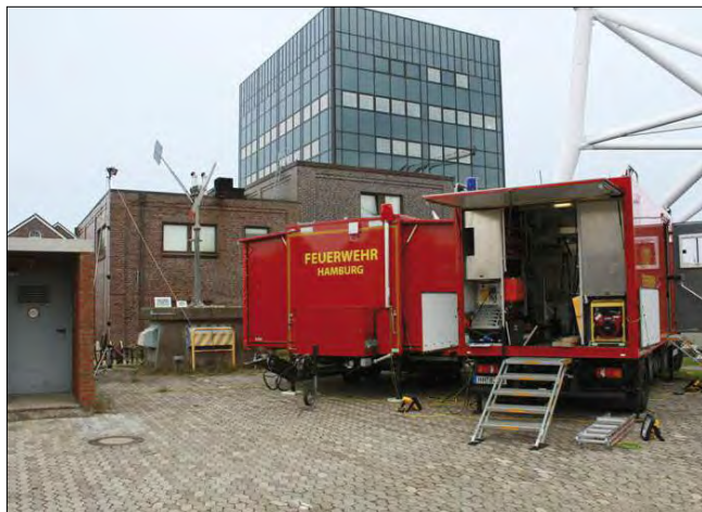
Knotenpunkt: Im Gerätewagen Fernmeldetechnik (GW Fm) laufen die Telefon-, ISDN-, Internet- und Faxverbindungen zusammen
