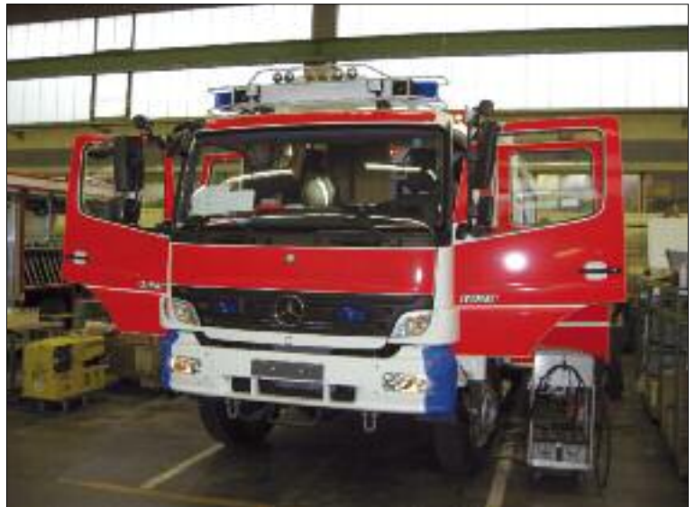
Die 6. Generation der Hamburger Löschfahrzeuge: In der 50. KW erfolgt die Gebrauchsabnahme des ersten Fahrzeugs, anschließend folgen die feuerwehrtechnische Beladung und Praxiserprobung
