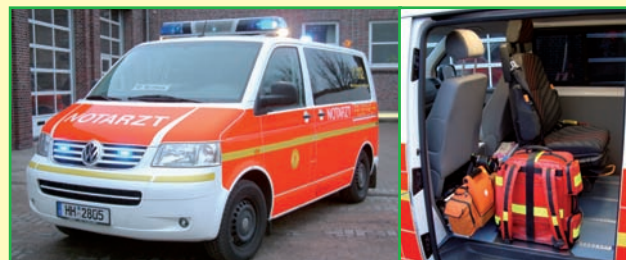
► Das neue NEF – ein VW T5 – überzeugt mit durchdachten Neuerungen wie zusätzlichem Kopf- und Seitenairbag, im Blaulichtbalken integrierten Arbeitsscheinwerfern sowie ergonomisch und einsatztechnisch vorteilhafter platzierten Geräten (z. B. Beatmungsgerät, Defibrillator, Rucksäcke). Außerdem verfügen die jetzt nach und nach in Dienst gestellten Fahrzeuge über eine Vorrüstung für Digitalfunk sowie ein Navigationssystem, dem die Koordinaten der Einsatzstelle vollautomatisch via HELS gesendet werden.
