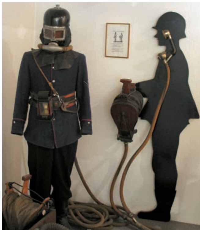
► Nur ein Feuerwehrmann: Rauchhelm der Firma König, Altona, mit integriertem Sprinklersystem und Gegensprechanlage (um 1905)
