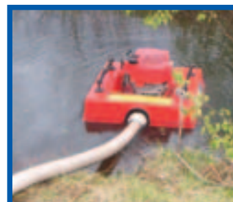
Wasser en masse: Die polnische Schwimmpumpe saugt das Wasser selbstständig an und verteilt es automatisch in die wasserführenden Schläuche.
