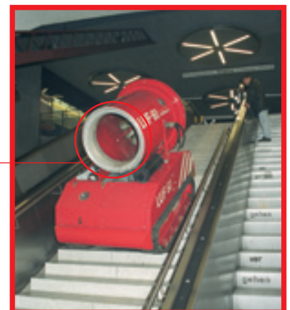
Dank einer meisterhaften Konstruktion kann das Kettenfahrzeug sogar Steigungen und Treppen bis 30° bewältigen . Eines Führerscheins bedarf der Anwender übrigens nicht, da LUF 60 zwar hoch effizient, aber mit einer „Höchstgeschwindigkeit“ von max. 6 km/h sehr langsam ist.
