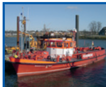
... und im Februar 2005: Das LB 31 wurde nicht nur grundüberholt, sondern außerdem mit einem Kran zur Bombenberingung sowie einer Bugstrahlleitung versehen, die auch Seitbewegungen (Querfahren) erlaubt.
