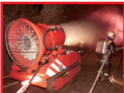
Selbst bei 13 % Sauerstoffgehalt in der Umgebungsluft bringt der Motor noch die volle Leistung. Die Wassereinspeisung erfolgt vom HLF aus über zwei C-Leitungen. Aus einer Distanz von bis zu 60 Metern kann LUF 60 die Wassermenge zur Brandbekämpfung gezielt versprühen.
