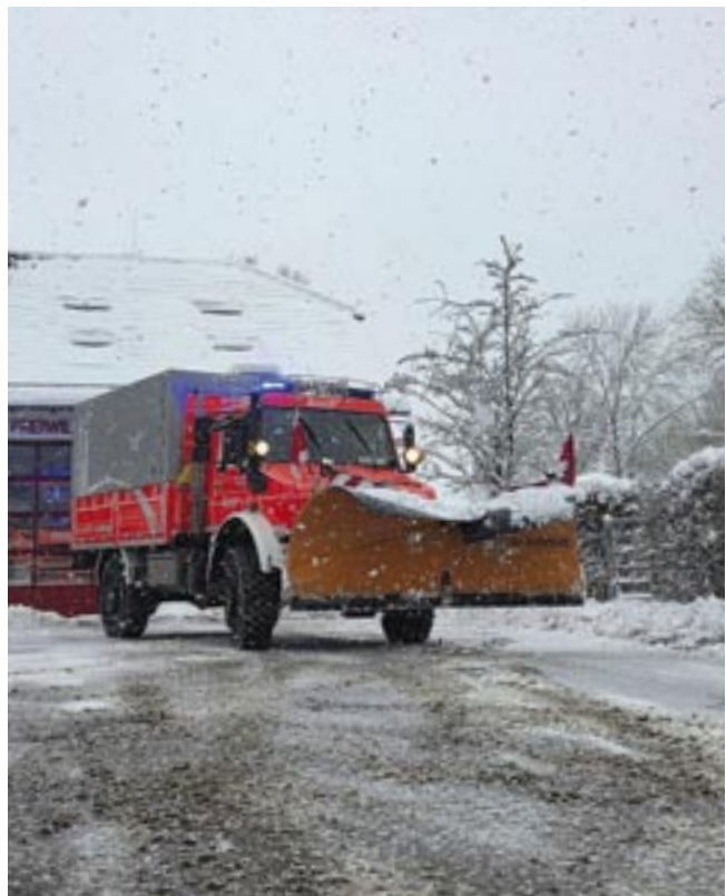
An einigen Wehren wurden die GW-R1 mit Schneepflügen ausgestattet, um damit Eis und Schnee zu beseitigen.
